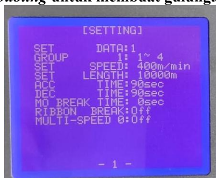
Gambar 2. Tampilan panel pada mesin doubling untuk mengatur kecepatan penggulungan ( set speed ), kecepatan akselerasi penggulungan ( acc time ), dan panjang untuk tiap gulungan benang ( set length )
