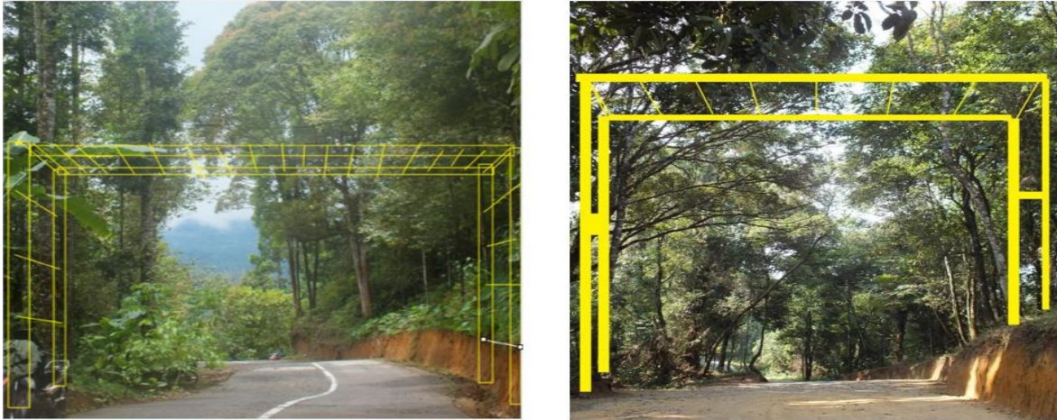
Gambar 3 a dan b. Usulan Perancangann Canopy Crossing
