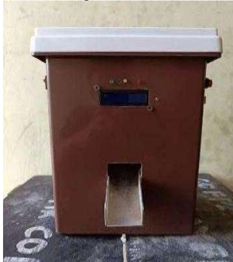
Gambar 3. Hasil Rancang Bangun Sistem Pakan Ayam Otomatis
